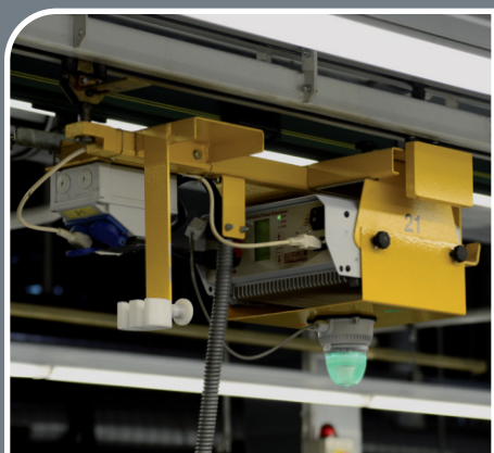
Einsatz Ladegerät mit Signallampe in der Fahrzeugfertigung
